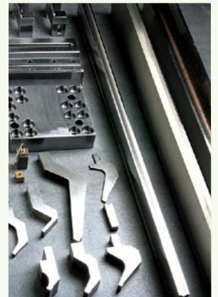
同社が手がけるプレーキプレス金型(手前左)、特殊金型(右)、部品加工(左奥)
