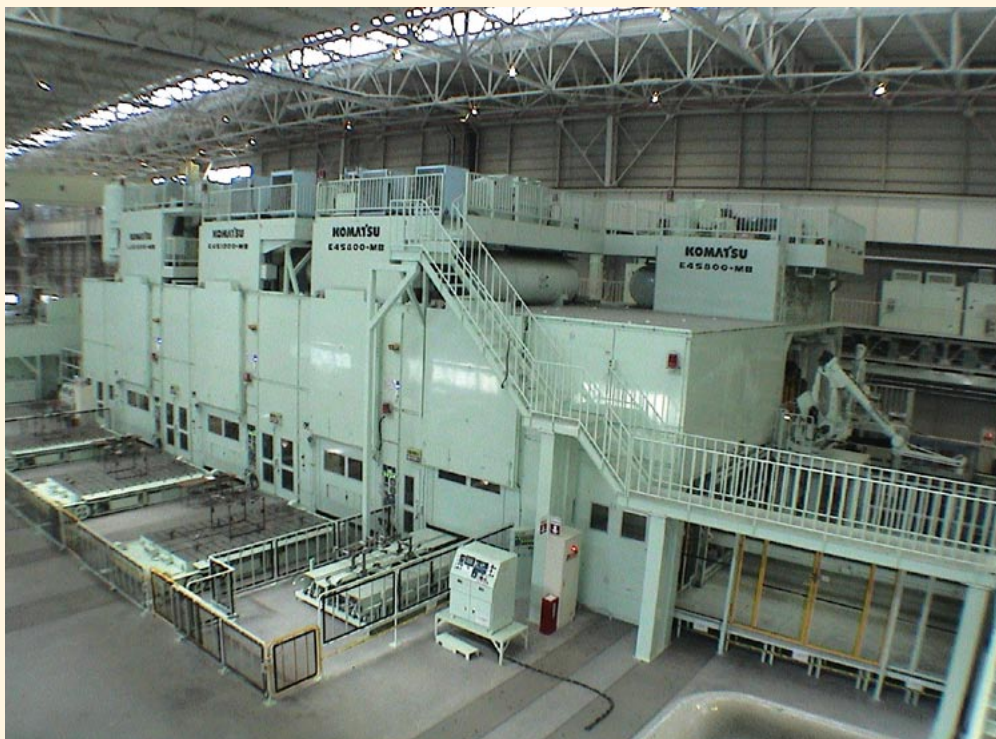
金沢工場で製造される自動車向け パネル成型用の大型プレス
